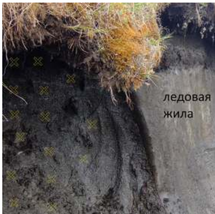
Рисунок 32 – Мёрзлый грунт и ледовая жила в ледовом комплексе на о. Курунгнах (фото автора); точки измерения магнитной восприимчивости отложений ледового комплекса отмечены жёлтыми крестиками
