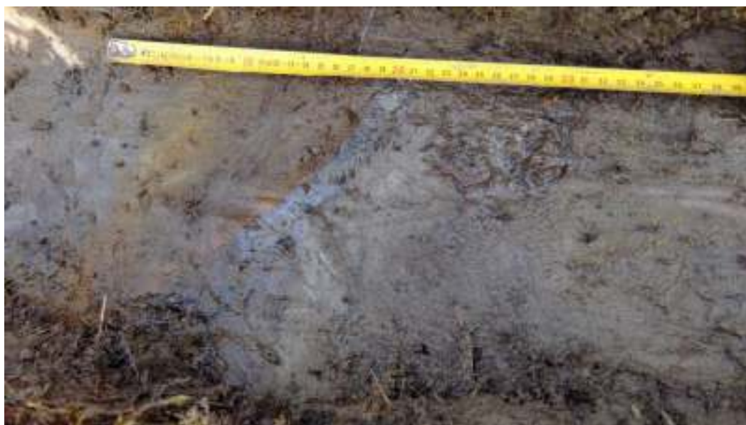
Рисунок 24 – Верхняя часть ледяной жилы в шурфе на участке 1 (о. Самойловский); данные о магнитной восприимчивости многолетнемёрзлых пород, вскрытых шурфом, представлены на рисунке 25
